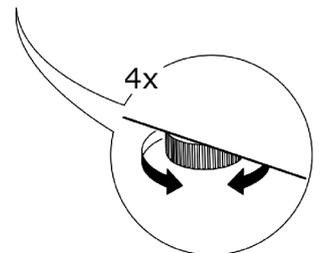
Перед установкой газлифта необходимо открутить гайки, снять шайбы с посадочного места газлифта.
